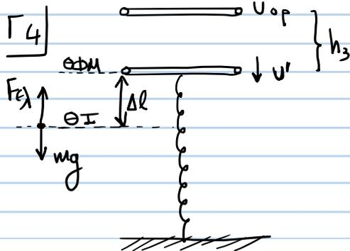
$$\Delta \text{MKE} : \frac{1}{2} m v'^2 - \frac{1}{2} m v_{op}^2 = mg h_3$$
