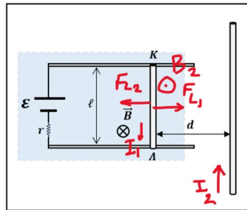
**I - α**  $I_{\text{δυρεπονει}}: \vec{F}_{L_2} \uparrow \downarrow \vec{F}_L, \text{ αραι } I_2 \uparrow \text{ ωπτε } B_2 \odot \text{ και } \vec{F}_{L_2} \text{ αριστερά.}$
