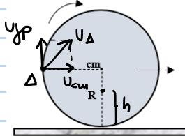
b) Για το σημείο M της κατασκευασμένης σημειότρου ισχυει:  $h = R - r \Rightarrow r = R - h$
